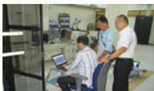
通信機器(GE-PON)の単体受取試験(PAT)
