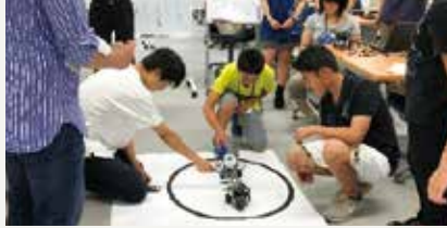
光センサ搭載ロボットによるライトレース実験 (九州大学)
