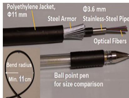
本プロジェクトで採用した日本製光ファイバーケーブル (ボールペンと同等の細さでも頑丈で信頼性が高い)
